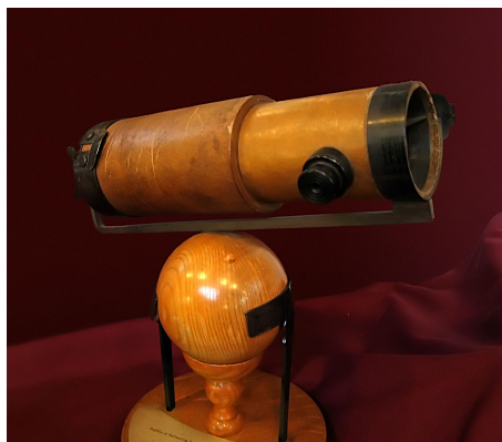
FIGURE 4 – Réplique du télescope de 6 pouces (150 mm) qu'Isaac Newton présenta à la Royal Society
