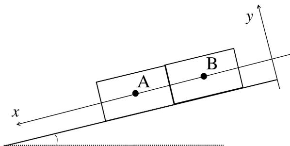
FIGURE 1 – Équilibre de 2 solides sur un plan incliné
