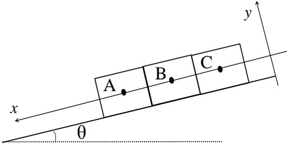
FIGURE 2 – Équilibre de 3 solides sur un plan incliné
